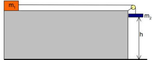
Sobald man das Gewichtsstück loslässt, setzt sich der Klotz nach rechts in Bewegung. Mit Hilfe der sog. *Dunkelzeit-Methode* wird die Geschwindigkeit für verschiedene Beschleunigungsstrecken  $s$  ermittelt.
